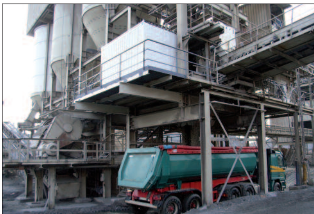
HAVER CPA 4 CONTAINER bei der Vermessung eines Schlacke-Sandgemisches
