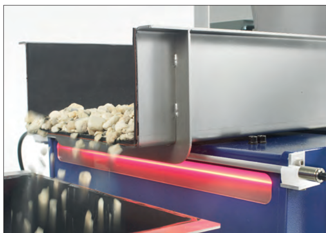
HAVER CPA 4-1 bei der Vermessung von Kies
