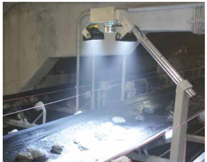
HAVER S 6-1 INLINE bei der Materialanalyse direkt über dem Förderband.
